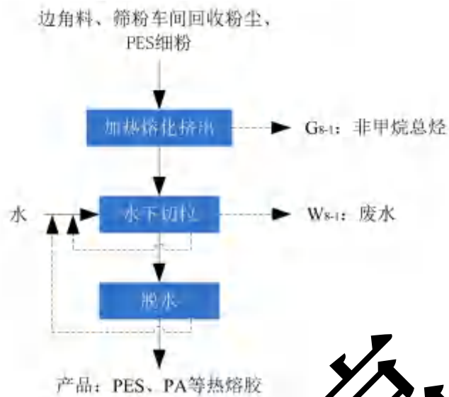
图 3.2-14 造粒工程工艺流程及产污环节示意图
