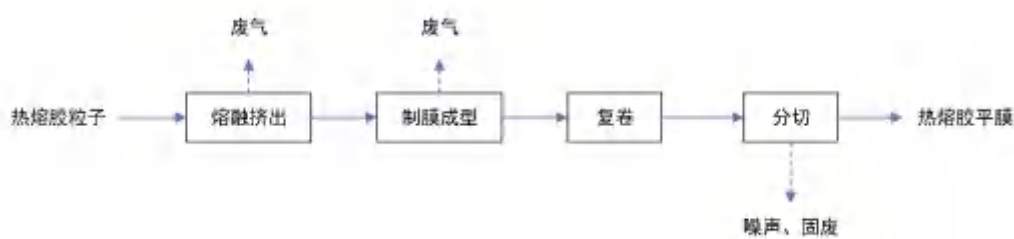
图 3.2-13 热熔胶膜生产工艺流程图
